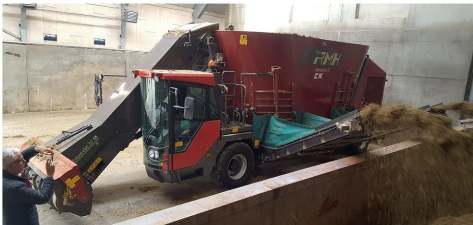
Поскольку вся техника RMH оснащена чувствительными и надёжными весовыми датчиками, данные с которых поступают в режиме реального времени на компьютер управляющего кормовым центром, вероятность загрузки каждого из компонентов с ошибкой значительно снижается. На приготовление смеси расходуется практически именно столько кормов, сколько предумо-
